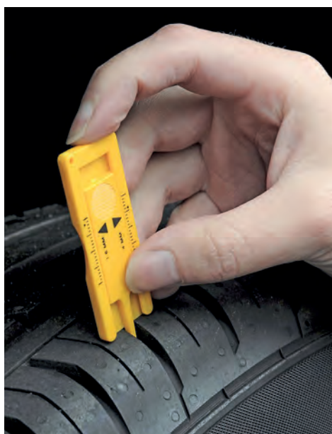
strumento per la misurazione dell'usura dei pneumatici
